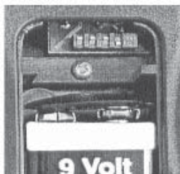
Figuur 3: "DIP-switches" in batterijhouder handzender
